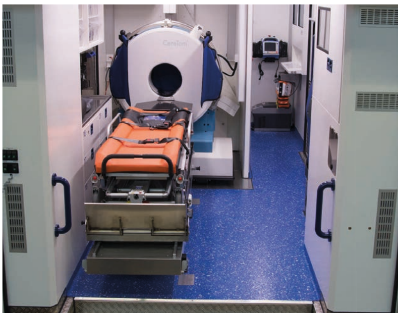
Abb. 6: Patientenraum Berliner STEMO mit CT und abgetrenntem Schaltraum
